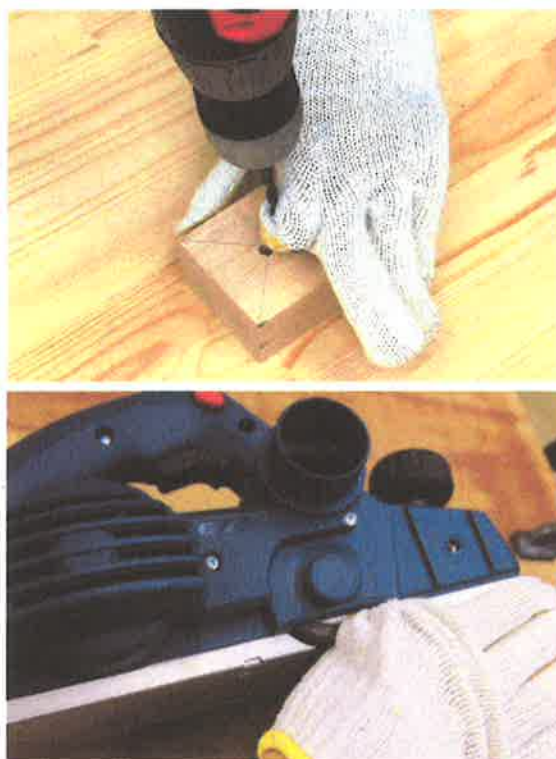
写真9. 上：電動ドリルを使用中に軍手が巻き込まれた様子
