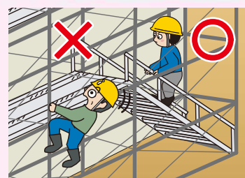
■近道行為の禁止(足場の伝い降りをしてはいけない)
